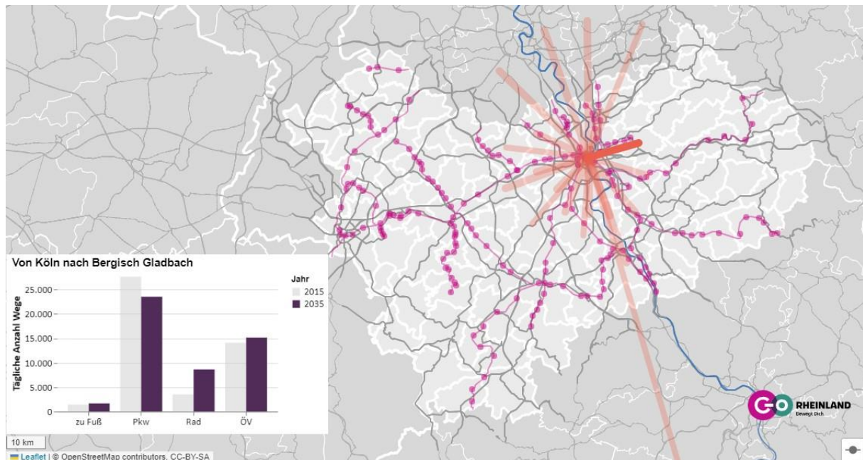
Abbildung 23: Anzahl der Wege und Modal Split zwischen Köln und Bergisch Gladbach in den Jahren 2015 und 2035. Andere Relationen können online auf der interaktiven Karte eingesehen werden.
